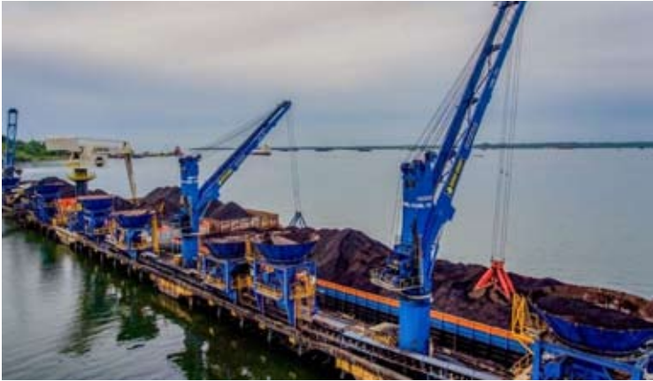
巴彦集团在印尼加里曼丹水域运营的浮式煤炭转运设施（浮式起重机）。
